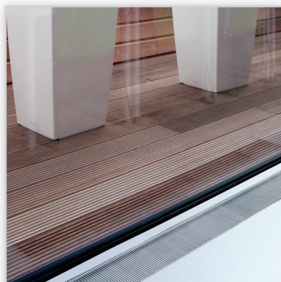
Model Mini Canal. Grzejnik kanałowy jest doskonałym rozwiązaniem przy dużych przeszkleniach. Dodatkowo model Mini Canal nie wymaga głębokiego kanału (min. 9 cm). Działa w technologii małej pojemności wodnej (Low H 2 O), montowany jest w stalowym korcie – galwanizowanym i lakierowanym. Do wyboru z kratkami drewnianymi lub metalowymi. Wymiary (wys./szer.) [cm]: 9-19/14-42. Moc [W]: od 237 do 3092.
