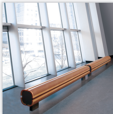
Model Knockonwood. Pierwszy na rynku grzejnik, którego obudowa wykonana jest z drewna: bukowego, zebrano, orzecha, mahoni, dębu, klonu i in. Knockonwood występuje w wersjach ściennej oraz wolno stojącej. Grzejnik oparty o ekonomiczną technologię małej pojemności wodnej (Low H 2 O) może być też wyposażony w system DBE zwiększający wydajność. Wymiary (wys./szer.) [cm]: 21/110-210. Moc [W]: od 452 do 5818.
