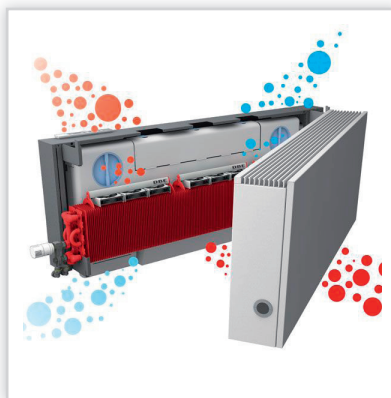
Model Jaga Fresh. Najnowszy system do poprawy jakości powietrza. Dostępny w grzejnikach ściennych Briza Fresh oraz Strada Fresh. Pomimo kompaktowych gabarytów oferuje aż sześć funkcji: grzanie, chłodzenie, filtrowanie, wentylację, rekuperację oraz chłodzenie nocne. Rekuperator składa się z dwóch bezobsługowych wentylatorów, wymiennika ciepła, filtrów powietrza (HAF 3M TM), czujnika CO 2 , czujnika wilgotności i systemu sterowania.
